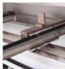
气动后托料, 后挡料气动毛刷辅助托料, 适用于薄板加工
